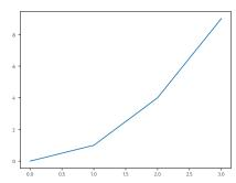
On observe que, par défaut, Python trace une ligne brisée bleue reliant les points donnés. Pour obtenir l'illusion d'une courbe, il suffit de placer suffisamment de points, dans la pratique on prendra par exemple 10\*\*3.
