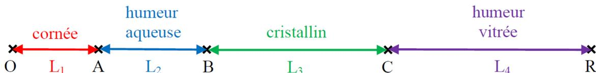
**B.4** On va déterminer la longueur de l'œil  $L$  en déterminant les 4 distances précédentes  $L = L_1 + L_2 + L_3 + L_4$ . On appelle  $\tau_1, \tau_2, \tau_3$  et  $\tau_4$  les quatre durées du tableau.
