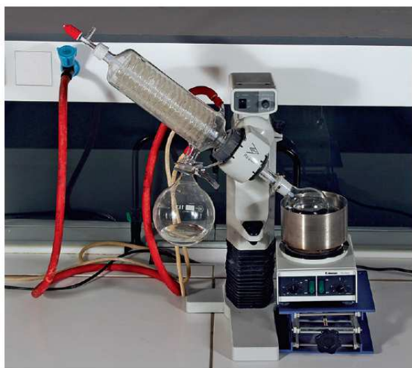
Doc. 4 L'évaporateur rotatif permet d'éliminer les solvants sous pression réduite.
