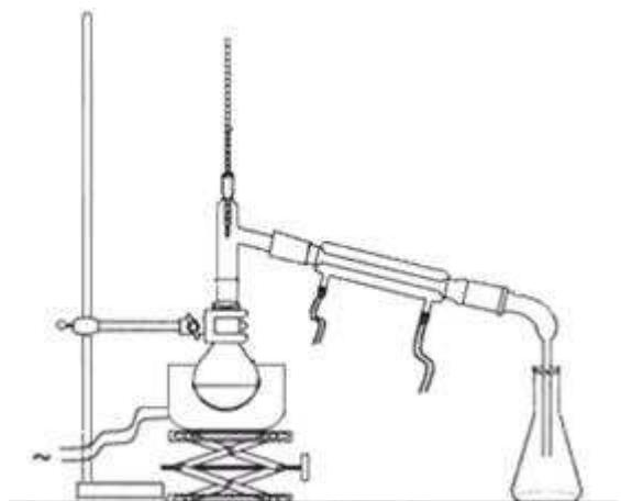
54. Sur le schéma ci-dessus, indiquer par des flèches les entrée et sortie de l'eau dans le réfrigérant.
