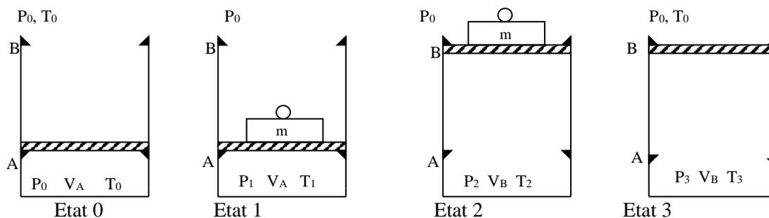
On place une masse  $m$  sur le piston et on chauffe très doucement le gaz par un moyen approprié, non représenté sur le schéma, jusqu'à ce que le piston décolle juste de la cale A (gaz dans l'état 1 :  $P_1, V_A, T_1$ ).
