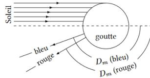
Figure 2: Déviation des rayons lumineux par une goutte d'eau
