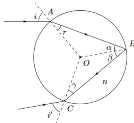
Figure 1: Trajet d'un rayon dans une goutte d'eau
