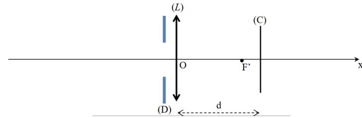
Figure 3: Modélisation de l'appareil photo
