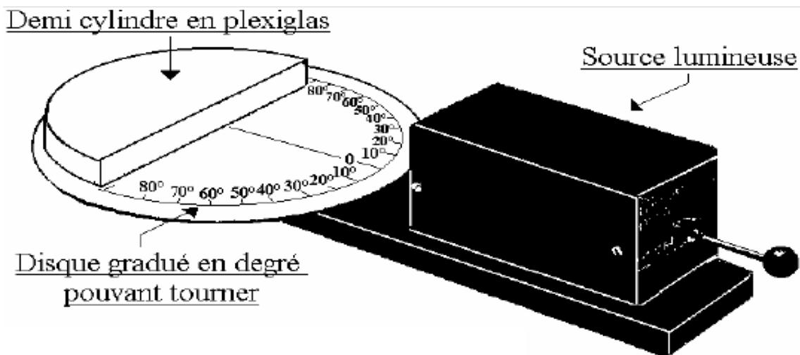
Cela nous permet de mesurer les angles  $i_1$  et  $i_2$ . À la suite des résultats expérimentaux trouvés, on cherchera à déterminer  $n_2$ , l'indice du plexiglas, de différentes façons. Soit:
