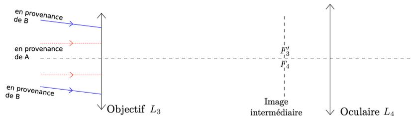
Pour étudier la lunette sur le banc optique de la salle de TP, il va falloir également "fabriquer" deux autres éléments essentiels : un objet à l'infini (qui joue le rôle de ce qu'observerait la lunette dans le ciel), et un œil.
