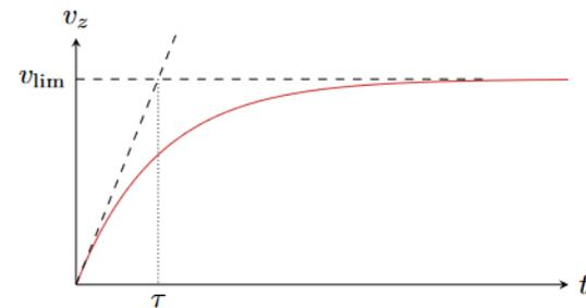
Figure 1: Tracé de la vitesse de la bulle en fonction du temps
