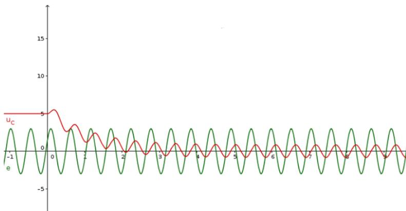
FIGURE 1 – Allure de  $u_c(t)$  lorsque le circuit est soumis à un forçage sinusoïdal. On voit qu'après un régime transitoire, de durée  $\tau = RC$  où les oscillations ne sont pas symétriques,  $u_c(t)$  devient oscillante en régime permanent.
