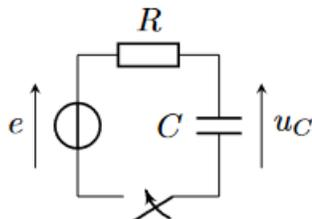
où  $E_m$  désigne l'amplitude du signal et  $\phi$  sa phase à l'origine. A l'instant initial  $t = 0$ , l'interrupteur est fermé. On suppose que le condensateur est initialement chargé, et on étudie la réponse du circuit  $u_c(t)$  à ce forçage. La figure ci-dessous illustre cette réponse.
