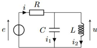
En appliquant la loi des noeuds, la loi des mailles et en utilisant les admittances complexes, exprimer l'amplitude complexe  $\underline{U}$  en fonction de  $\underline{E}$ ,  $R$ ,  $L$ ,  $C$  et  $\omega$ .
