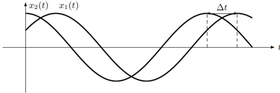
FIGURE 2 – Illustration du déphasage sur deux signaux  $x_2(t)$  et  $x_1(t)$ . La différence de phase est ici positive, cela signifie que le signal  $x_2$  est en avance de phase sur le signal  $x_1$ . On peut également le voir car  $x_2$  passe en premier par son maximum.
