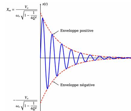
Figure 1: Allure du déplacement  $x(t)$  du verre
