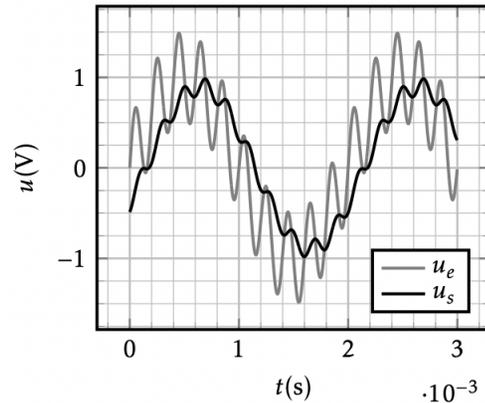
Figure 3: Signal d'entrée  $u_e$  et signal  $u_s$  en sortie du filtre
