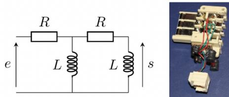
Figure 1: Filtre ADSL et modélisation
