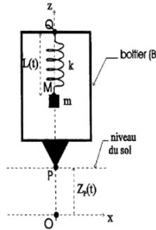
Figure 2: Principe du sismomètre
