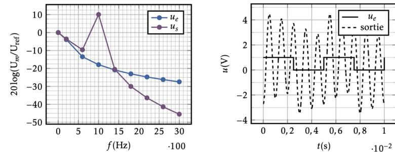
Figure 2: Spectre du signal en sortie du filtre et représentation temporelle
