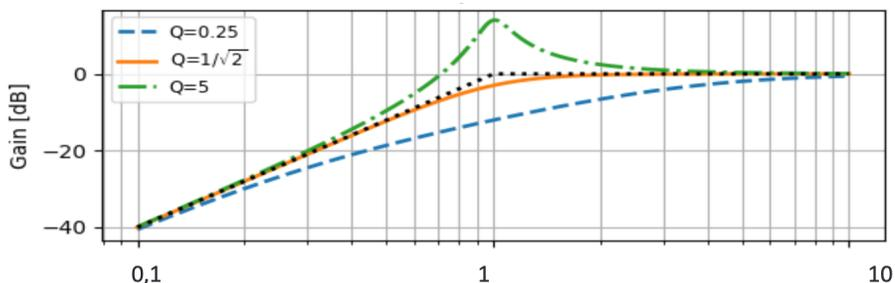
Figure 1: Diagramme de Bode : représentation du gain en décibels en fonction de  $x = \omega/\omega_0$
