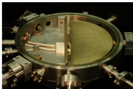
FIGURE 1 – Schéma de principe et photo du cyclotron de l'université de Rutgers, qui mesure une trentaine de centimètres de diamètre.
