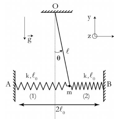
On déplace légèrement  $M$  par rapport à la verticale puis on le laisse évoluer librement. Il oscille alors en décrivant un petit arc de cercle de centre  $O$ , dans un plan vertical, et on repère sa position par l'angle  $\theta$  avec la verticale. Cet angle restant toujours faible, on pourra considérer que les ressorts restent horizontaux.
