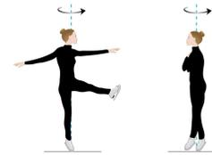
Une patineuse tourne sur elle-même avec une de ses jambes et ses bras perpendiculaire à son corps (schéma ci-dessous): sa vitesse angulaire vaut  $8 \text{ rad/s}$  et son moment d'inertie vaut  $3,6 \text{ kg.m}^2$ . En ramenant sa jambe à la verticale et en levant ses bras au-dessus de sa tête (schéma ci-dessous), elle diminue son moment d'inertie à  $1,6 \text{ kg.m}^2$  et sa vitesse angulaire augmente pour atteindre  $18 \text{ rad/s}$ .
