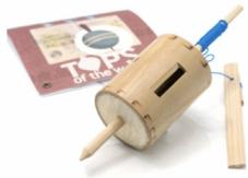
On modélise le lancer d'une toupie à l'aide d'un fil inextensible enroulé sur quatre tours sur le corps de la toupie. La toupie est modélisée par un cylindre de masse  $m$  et de rayon  $R$ , de moment d'inertie par rapport à son axe  $mR^2/2$ . Une pointe de moment d'inertie négligeable permet à la toupie de tenir sur le sol horizontal.
