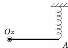
Considérons le système mécanique représenté ci-contre, constitué d'une barre de masse  $m$ , de longueur  $OA = 2a$ , libre de tourner sans frottement autour de l'axe  $Oz$ . Son moment d'inertie par rapport à cet axe vaut  $I_z = 3ma^2/4$ . Elle est attachée en  $A$  à un ressort de longueur à vide  $l_0$  et de raideur  $k$ . L'autre extrémité du ressort est fixe.
