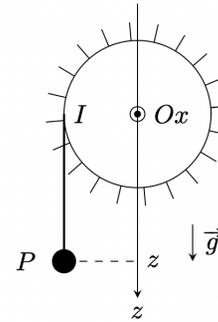
Un régulateur d'Archereau-Foucault, schématisé ci-contre, est un dispositif ancien qui a été utilisé par exemple en horlogerie ou dans des boîtes à musique. On le modélise de façon simple par un contrepoids  $P$  de masse  $m$  accroché à un fil de masse négligeable devant  $m$ . Le fil est enroulé autour d'un cylindre tournant librement autour de son axe  $Ox$  fixé à un bâti, de rayon  $R$  et de moment d'inertie  $J_x$ . La chute de  $P$  entraîne la mise en rotation du cylindre.
