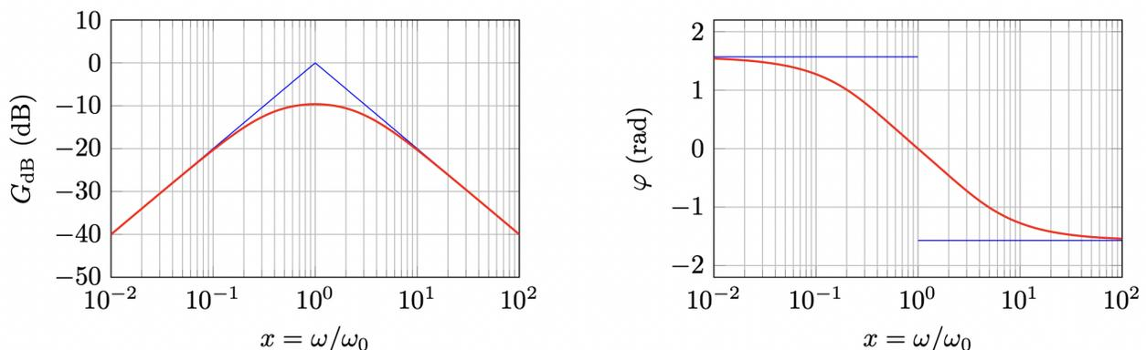
FIGURE 1 – Diagramme de Bode du filtre de Wien : diagramme asymptotique en bleu, diagramme réel en rouge.
