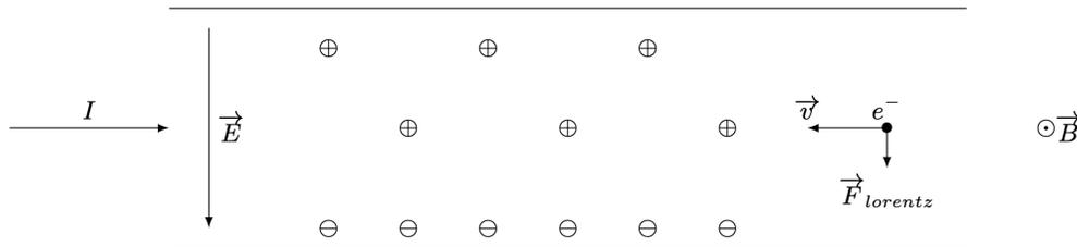
FIGURE 13 – Origine microscopique de la force de Laplace
