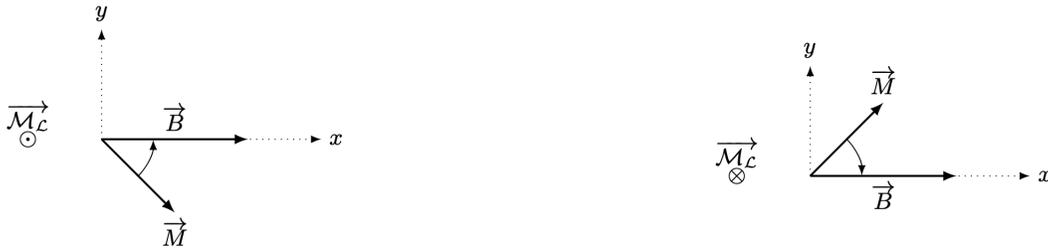
FIGURE 15 – Effet mécanique d'un couple de Laplace
