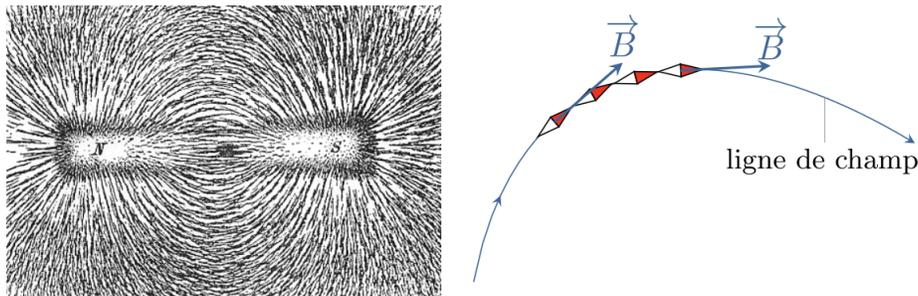
FIGURE 2 – Lignes de champ  $\vec{B}$  d'un aimant permanent : les lignes de champ sont visualisées à l'aide de grains de limaille de fer, qui se comportent comme des petites boussoles, matérialisant ainsi les lignes de champ magnétique de l'aimant.
