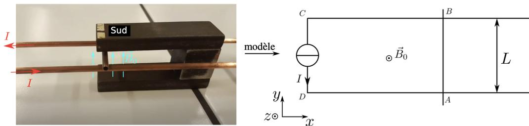
FIGURE 12 – Photo et modélisation de l'expérience des rails de Laplace. À l'intérieur du "U", les lignes de champ seront supposées perpendiculaires au circuit.
