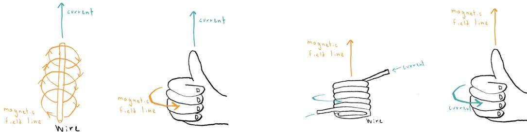
FIGURE 3 – Illustration de la règle du tire-bouchon
