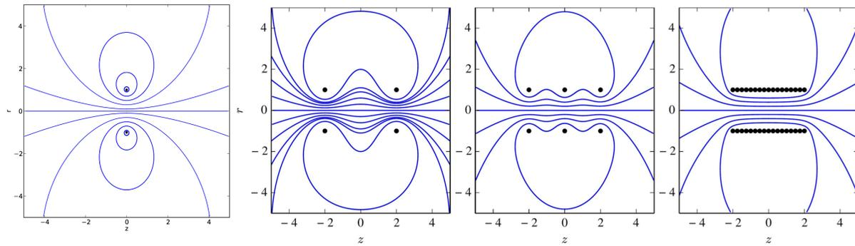
FIGURE 5 – ”Fabrication” d’une bobine : on place une, deux, trois puis  $N$  spires de courant pour former un solénoïde.
