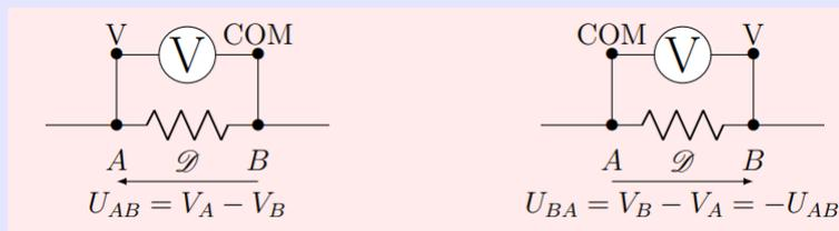
FIGURE 5 – Mesure de la tension électrique
