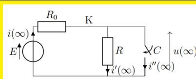
En régime permanent, le condensateur est équivalent à un interrupteur ouvert et la bobine est équivalente à un fil  $i''(\infty) = 0$ .
