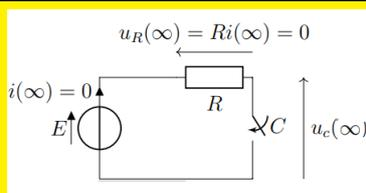
En régime permanent,  $u_c$  ne dépend pas du temps, donc  $i(t) = C \frac{du_c}{dt} = 0$ , donc le condensateur est équivalent à un interrupteur ouvert, donc  $i(\infty) = 0$ .
