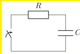
1. Établir l'équation différentielle vérifiée par la tension aux bornes du condensateur (voir § II.4)
