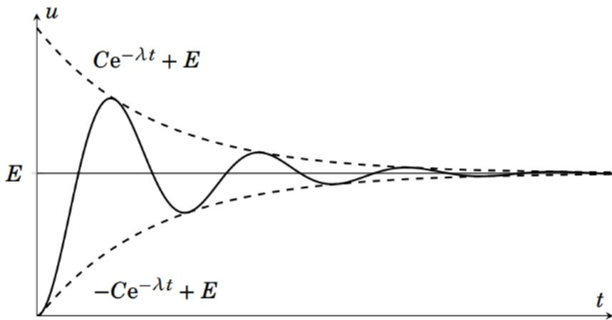
4B) Déterminer le type de régime transitoire pour  $R = 10 \text{ k}\Omega$ ,  $L = 1 \text{ mH}$  et  $C = 100 \text{ nF}$ . 1 pt
