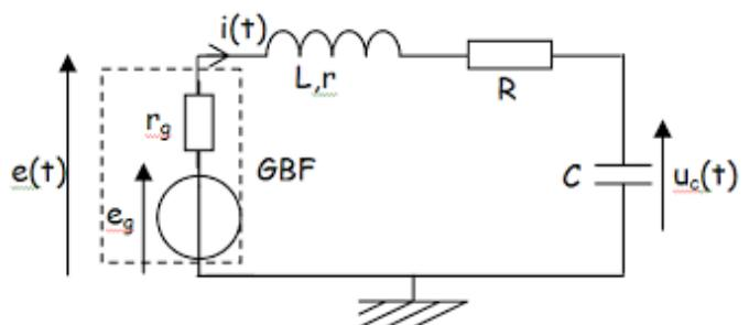
1. Déterminer les valeurs de  $C$  et  $R$  pour obtenir un oscillateur amorti avec  $f_0 = 5 \text{ kHz}$  et  $Q = 5$ .
