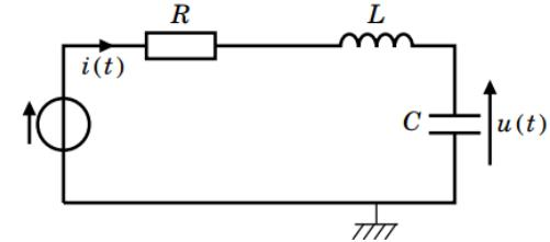
On s'intéresse à la réponse en tension  $u(t)$  que l'on cherche sous la forme :
