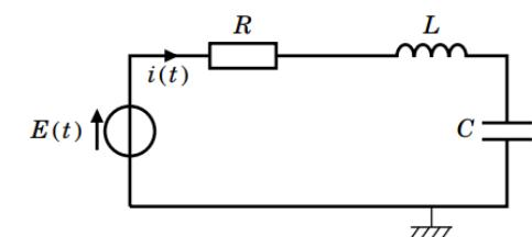
Le générateur idéal de tension délivre une tension  $e(t) = E \cos(\omega t)$ .
