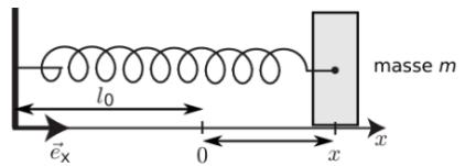
1. Faire un bilan des forces sur le système masse, appliquer le principe fondamental de la dynamique et en déduire l'équation portant sur la position  $x(t)$ .
