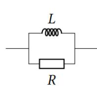
1 - Déterminer en fonction de  $\omega$  les valeurs de  $R'$  et  $L'$  pour lesquelles les deux dipôles sont équivalents.
