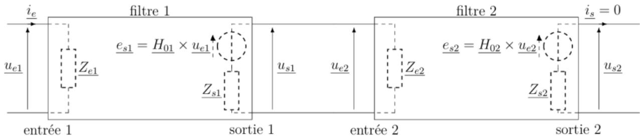
Avec  $\underline{H}_{01}$  et  $\underline{H}_{02}$  les fonctions de transfert à vide des deux filtres.
