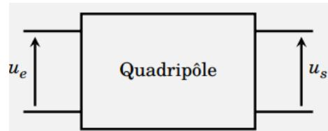
Le but d'un quadripôle est généralement d'appliquer un **traitement au signal d'entrée** (calcul de moyenne, intégration, filtrage, amplification...) et d'obtenir le signal traité aux bornes de sortie.
