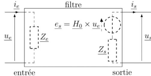
En sortie, l'action du filtre sur ce qui se situe après est modélisée par un générateur réel, association d'une source idéale de tension  $e_s = H_0 \times u_e$  et d'une **impédance de sortie**  $Z_s$ .
