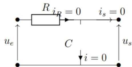
**A haute fréquence**, le condensateur est équivalent à un fil.
