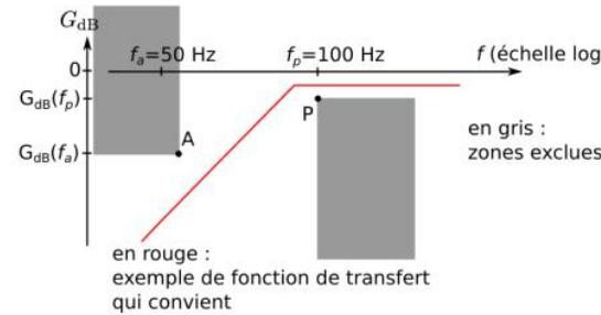
2. Il faut calculer la pente minimale que doit avoir  $G_{dB}$  dans le diagramme de Bode. Cette pente minimale est la pente entre les points A et P ci-dessus.
