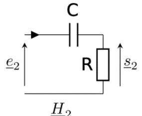
*On souhaite associer les deux filtres afin de réaliser un filtre passe-bande.*
