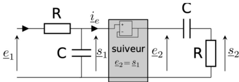
★ Réaliser la mise en cascade des deux filtres, en intercalant entre les deux un suiveur.
