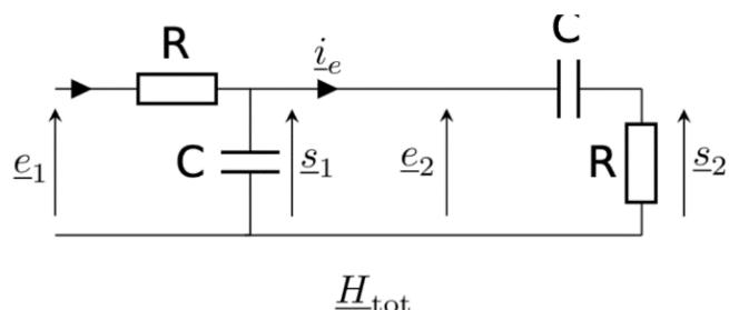
*Comme nous relierons la sortie du filtre 1 (tension  $s_1$ ) à l'entrée du filtre 2 (tension  $e_2$ ), on a  $s_1 = e_2$ .*
