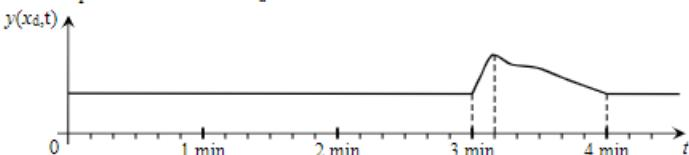
↗ L'onde apparaît toujours « à l'envers » quand on compare le graphe temporel à  $x$  donné et le graphe spatial à  $t$  donné : ici le point considéré monte d'abord très vite, lorsqu'il est atteint par le front de la vague, puis redescend lentement au fur et à mesure que le « dos » passe.
