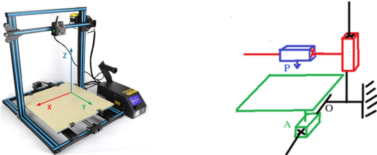
FIGURE 1 – Imprimante 3D cartésienne (image à gauche et schéma cinématique à droite).
