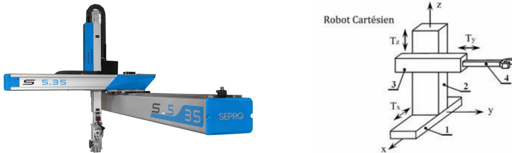
FIGURE 1 – Robot cartésien S5 Line (à gauche) et modélisation de principe d'un robot cartésien quelconque (à droite).
