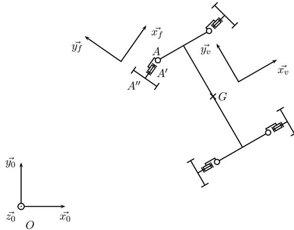
FIGURE 1 – Schéma cinématique d'une voiture à quatre roues motrices.
