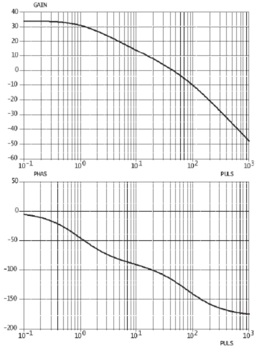
FIGURE 3 – Diagramme de Bode du système D
