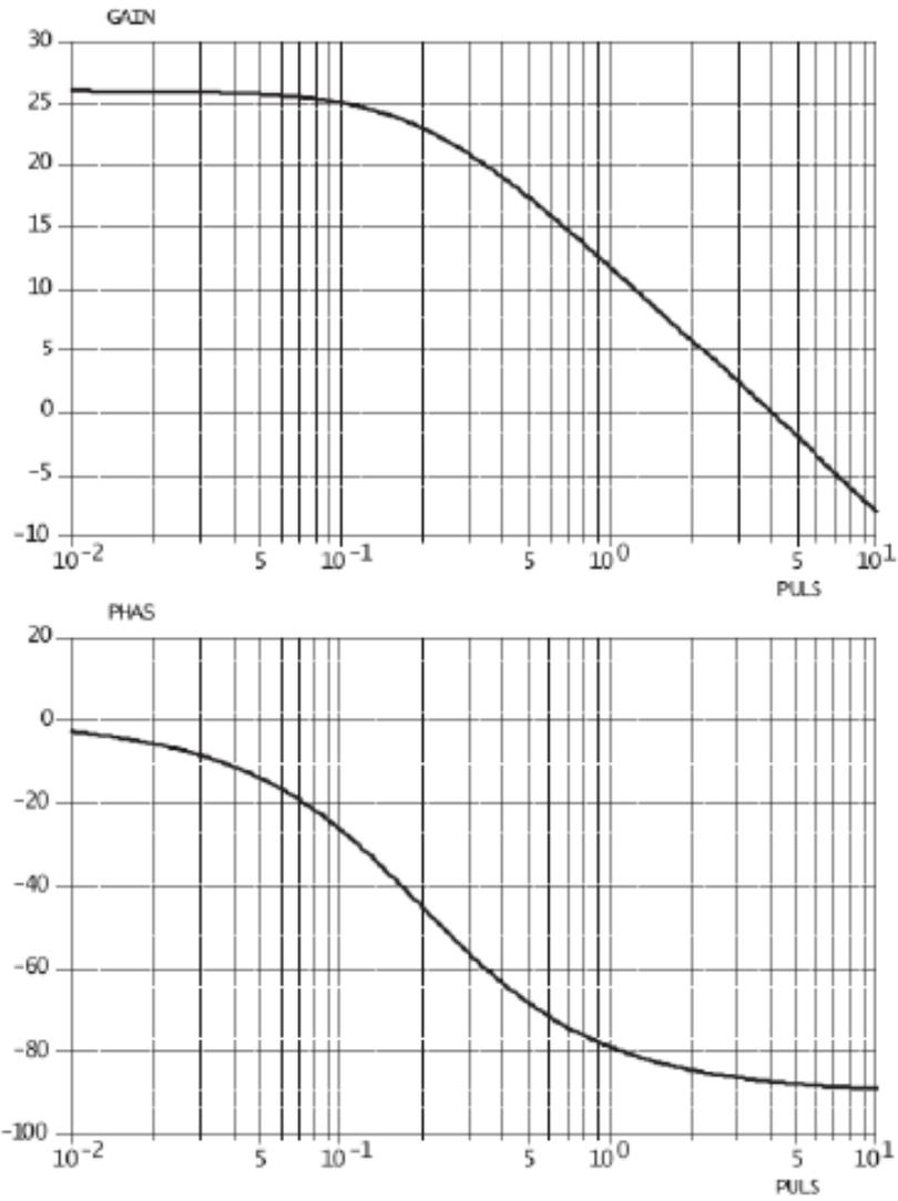
FIGURE 1 – Diagramme de Bode du système C
