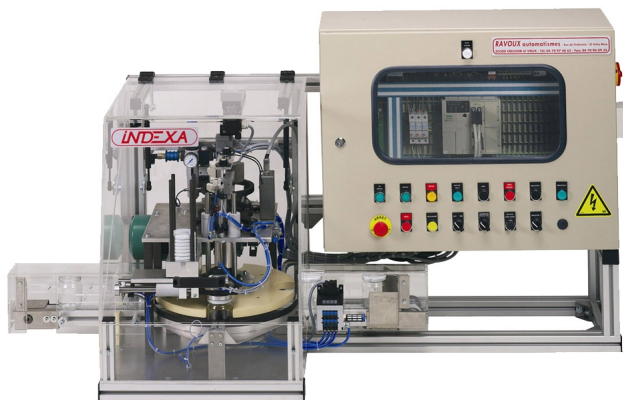
FIGURE 2 – Capsuleuse à bocaux Indexa (à gauche) où on observe l'arrivée des bocaux à gauche et un plateau tournant déplaçant les bocaux. À droite, un modèle numérique 3D de système de mise en rotation du plateau de la capsuleuse.
