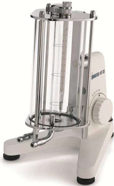
A gauche : un viscosimètre à chute de bille.
