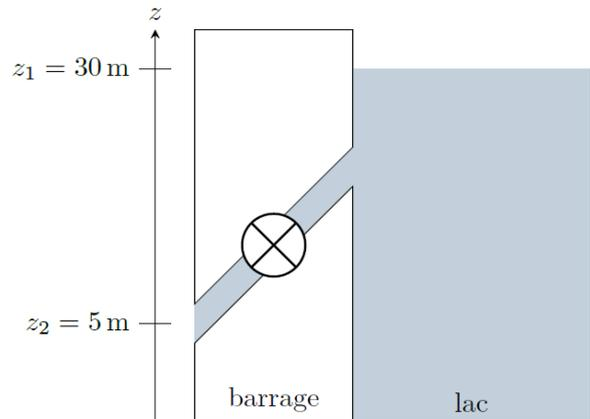
La vitesse à la surface du lac sera quasiment nulle, étant donné la taille très élevée de la surface du lac devant la section de la conduite par laquelle a lieu l'écoulement. Vitesse en sortie de la conduite :
