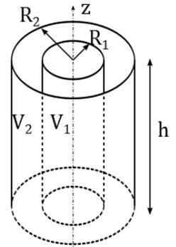
Etablir l'expression de la capacité puis de la capacité linéique d'un tel condensateur cylindrique.
