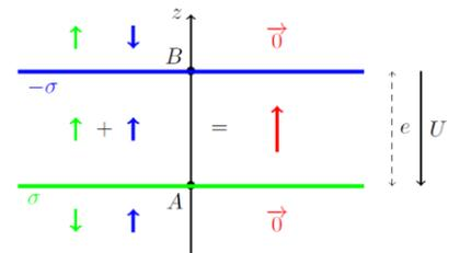
Principe de superposition :  $\vec{E} = \vec{E}_1 + \vec{E}_2$
