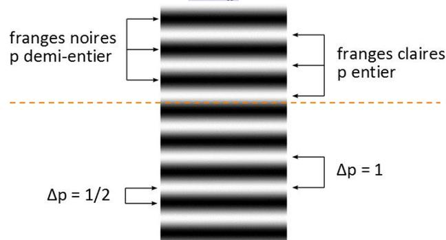
Ici  $D = 1,20 \text{ m}$ ,  $\lambda = 680 \text{ nm}$  et  $a = 0,20 \text{ mm}$ , d'où  $i = \frac{\lambda D}{a} = 4,08 \text{ mm}$  ;
