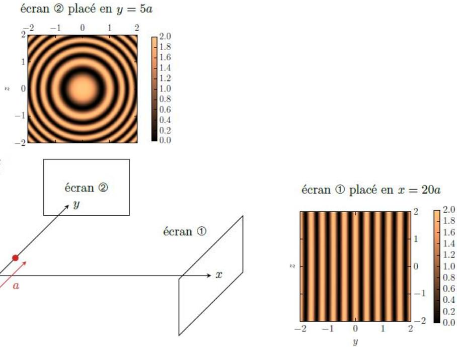
Interférences constructives (resp. destructives) en C si  $\delta = S_1S_2 = m\lambda$  (resp.  $(m + \frac{1}{2})\lambda$ ), avec  $m$  entier.
