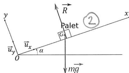
5. On reprend la projection du principe fondamental de la dynamique sur (Ox) en l'absence de propulsion :
