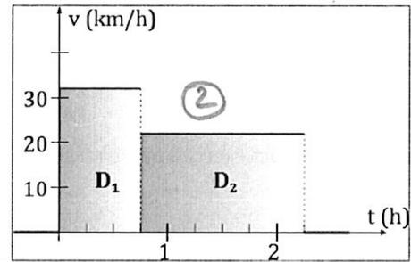
3. Aire  $\mathcal{A}_1$  sous la courbe pendant la 1<sup>ère</sup> période de durée  $\Delta t_1 = 45 \text{ min} = \frac{3}{4} \text{ h}$  :
