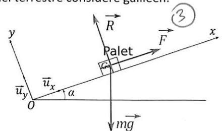
2. Principe fondamental de la dynamique appliqué au palet de masse  $m$  dans le référentiel terrestre supposé galiléen :
