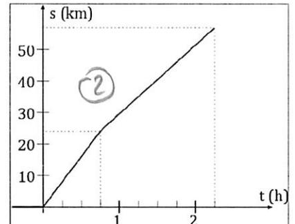
6. Équation  $s(t)$  : mouvements correspondant à des mouvements rectilignes uniformes à vitesse constante, on a alors :
