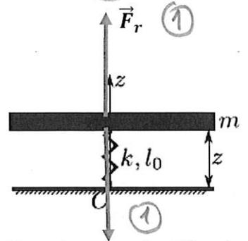
② 2.  $\vec{P} = m\vec{g}$  liée à l'énergie potentielle de pesanteur  $E_{pp} = +mgz + cte$  ①
