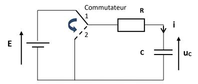
Commutateur en **position 1** : Etablir l'équation différentielle vérifiée par  $u_c(t)$  et la mettre sous forme canonique. Identifier la constante de temps  $\tau$  caractéristique du régime transitoire. Résoudre cette équation différentielle compte-tenu de la condition initiale  $u_c(0) = 0$ .
