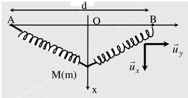
Figure 3 – Trampoline avec deux ressorts
