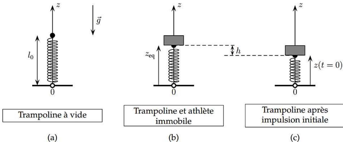
Figure 1 – Trampoline avec un ressort dans différentes configurations
