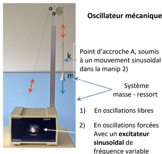
**Aux fréquences moyennes** : passage par des oscillations **d'amplitude particulièrement élevée**, nettement supérieure à l'amplitude de l'excitation, pulsation de l'excitation
