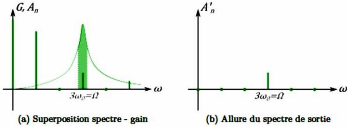
FIGURE 16 –  $Q \gg 1$  : seul l'harmonique correspondant à la fréquence centrale du filtre est restitué correctement.
