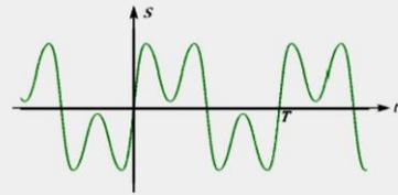
FIGURE 19 – Signal obtenu en sortie d'un filtre passe-bande de facteur de qualité  $Q = 1$ . Le filtrage n'est pas assez sélectif : le signal de sortie n'est pas une sinusoïde.
