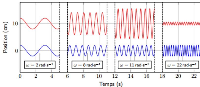
FIGURE 7 – Évolution au cours du temps de la position de la masse en régime permanent (en rouge) pour différentes pulsations d'excitations  $\omega$  du support
