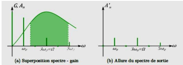
FIGURE 18 – Pour un filtre peu sélectif, les harmoniques  $\omega_0$  et  $5\omega_0$  ne sont pas complètement éliminés.
