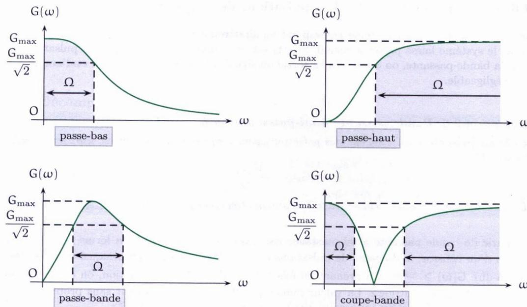
FIG. 2.3. Gabarits des filtres classiques. Les diagrammes représentés ne sont pas en échelle logarithmique, d'où l'absence d'asymptotes.
