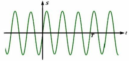
FIGURE 17 – Signal obtenu en sortie d'un filtre passe-bande de facteur de qualité  $Q = 50$ . Le filtrage isole bien l'harmonique de pulsation  $3\omega_0 = \Omega$ .
