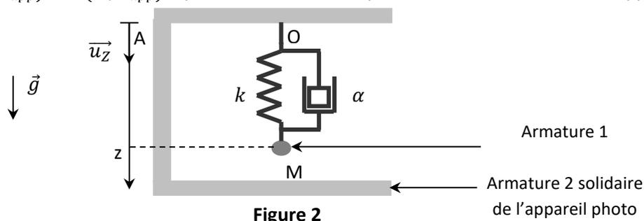
On s'intéresse à la détermination de l'amplitude  $Z_0$  de la vibration engendrée par le tremblement du photographe. On considère pour cela que le point  $O$  oscille verticalement à la pulsation  $\omega$  avec une amplitude  $Z_0$  dans le référentiel terrestre considéré comme galiléen. Sa position est repérée par sa cote  $z_0(t) = Z_0 \cos(\omega t)$ .
