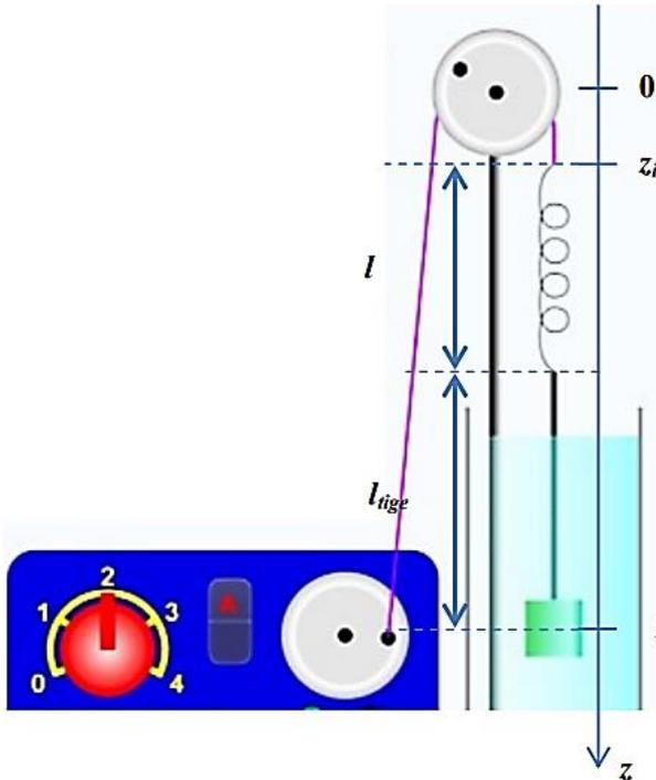
L'excitation est réalisée par un moteur à vitesse variable, relié à une excentrique.
