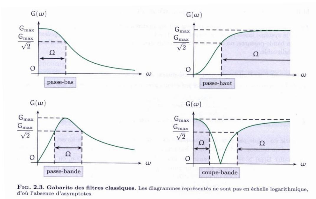
FIG. 2.3. Gabarits des filtres classiques. Les diagrammes représentés ne sont pas en échelle logarithmique, d'où l'absence d'asymptotes.
