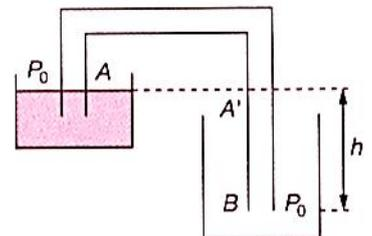
a) Le siphon a été amorcé, c'est-à-dire qu'on l'a rempli d'eau en aspirant en B. En supposant qu'il y a équilibre, relier les pressions en A et B. On notera  $h$  la distance entre B et A'.
