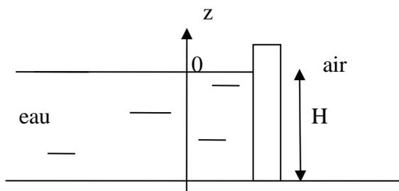
Hauteur immergée  $H = 25\text{m}$  sur une largeur  $L = 300\text{m}$ .
