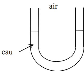
Dans un tube en U de section  $1\text{cm}^2$ , on place de l'eau comme l'indique le schéma ci-dessous :
