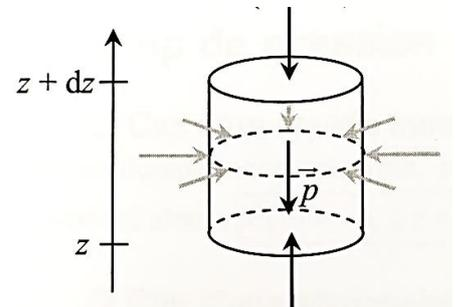
Elément de volume d'axe vertical, de section  $dS$  et de hauteur  $dz$  :
