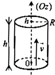
1. Appliquer le PFD au fluide contenu dans un cylindre de rayon  $r$  inférieur à  $R$  et de hauteur  $h$ , sachant que l'on est en régime permanent. Pour fixer le signe de la force de cisaillement subie par le fluide, on remarquera que  $\frac{\partial v}{\partial r} < 0$ , la vitesse étant nulle sur la paroi de l'artère en  $r = R$ . En déduire  $\frac{\partial v}{\partial r}$  puis  $v(r)$ .
