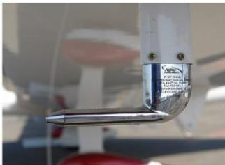
Figure 3 – Sonde de Pitot sur un avion.
