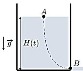
Soit un réservoir cylindrique de section  $S$ , initialement rempli d'eau avec une hauteur  $H_0$ . On perce au point  $B$ , au fond de ce réservoir, un orifice de section  $s \ll S$ , par lequel il se vide. On suppose étudier la vidange dans une approximation de régime quasi-stationnaire.
