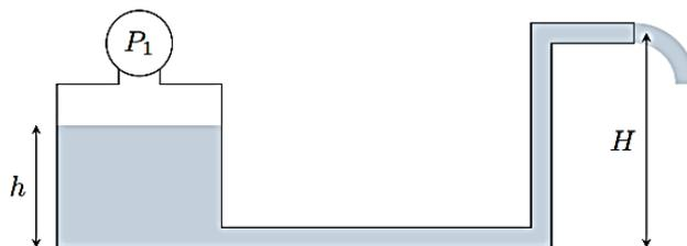
Au sein d'une installation industrielle, on doit pomper de l'eau dans une citerne posée sur le sol, pour l'éjecter dans l'atmosphère, à une hauteur  $H = 5$  m au dessus du sol, avec un débit minimal  $Q = 5 \text{ L} \cdot \text{s}^{-1}$  dans une conduite de diamètre  $D = 5$  cm. On note  $\Delta h = 0,5$  m la perte de charge totale exprimée en hauteur équivalente.
