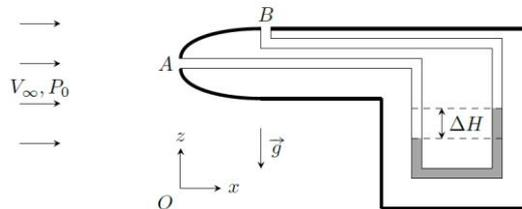
Figure 4 – Schéma de principe d'une sonde de Pitot.
