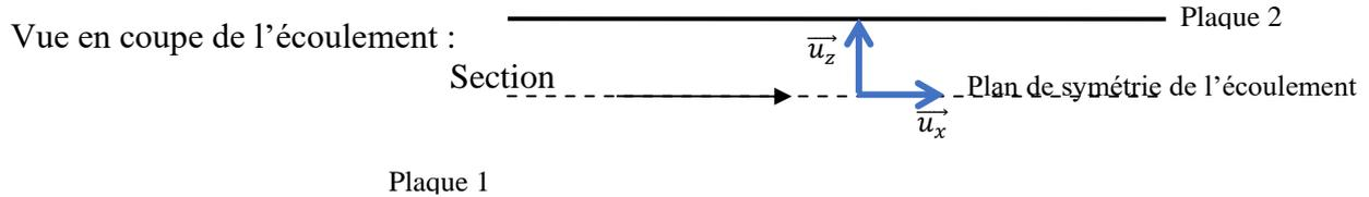
Entre les 2 plaques, la vitesse  $\vec{v}$  du fluide dépend de la distance  $z$  au plan de symétrie de l'écoulement :  $\vec{v} = v_0 \cdot \left(1 - \left(\frac{z}{e}\right)^2\right) \cdot \vec{u}_x$
